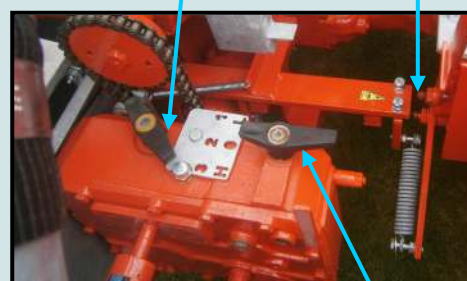
Håndhjul for korrigerig mod dårlig tandhjuls-indgreb i gearkassen.
