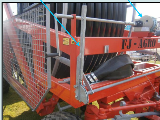
Ekstraustyr: Solcelle for Program Regn 10. El-styring på tromlebremse. El-styring på stopventil.
