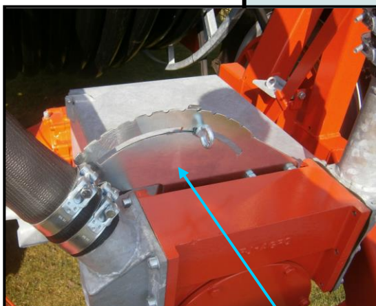
Manuel hastighedsstyring på vandturbine.
