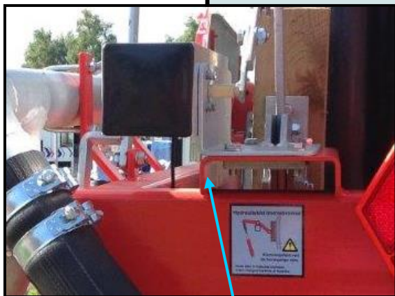
Elektrisk tromlebremse i forbindelse med Program Regn 10. (ekstraudstyr).
