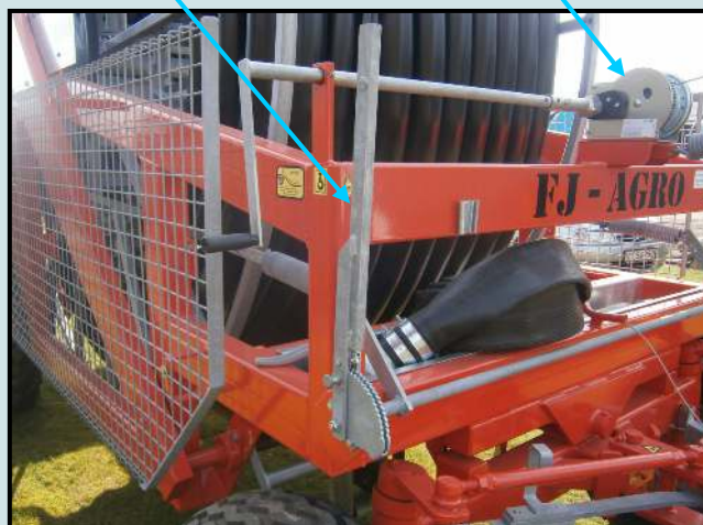
Ekstraudstyr: Solcelle for Program Regn 10. El-styring på tromlebremse. El-styring på stopventil.
